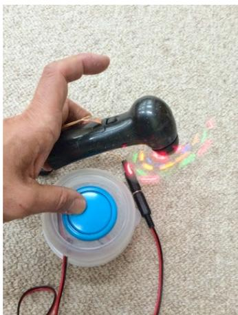
光る扇風機の電池BOXに長細い銅板で作ったBDアダプタを突っ込みスイッチ操作可能にした。障害特性として、見えづらさのある重度重複障害の子どもにとって、きれいに光ることと、風があたることで、とても視認しやすい教材となる。また、子どもが見るだけでなく自分でスイッチを押して能動的に関わることができる。スイッチで動くことの因果関係を知る経験をするためにはよい教材である。
