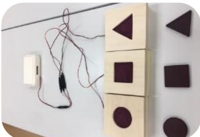
○△□の形を弁別する教材である。正しい形を型に入れるとピンポンチャイムが鳴るようになっている。型は3つに分割されているので、二択にしたり、三択にしたりするなど難易度を調整することができる。
