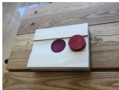
電動歯ブラシに使用される振動モーターを利用し、丸い形を枠にはめると振動のフィードバックが得られる教材を作製した。木の板の加工に時間がかかると思われたが、10人分の教材部品を分担して加工したことにより、予想していた時間よりも短時間で完成させることができた。
