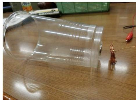
「エナメル線を太くする」のグループは、電流の大きさの違いも検流計で測定していた。「コップを小さくする」のグループは段階的に小さくし、音の聞こえ方の違いを確かめていた。「磁石の磁力を強くする」のグループは枚数を増やしたことでコップの底の振動が弱まり、かえって音が小さくなってしまった。実験結果を基に学級全体で話し合ったところ、音を大きくさせることに最も効果的であったのは、コイルの巻き数を増やすこととコイルの輪を小さくすることの2点であったとの結論に達した。ここで、分解した
